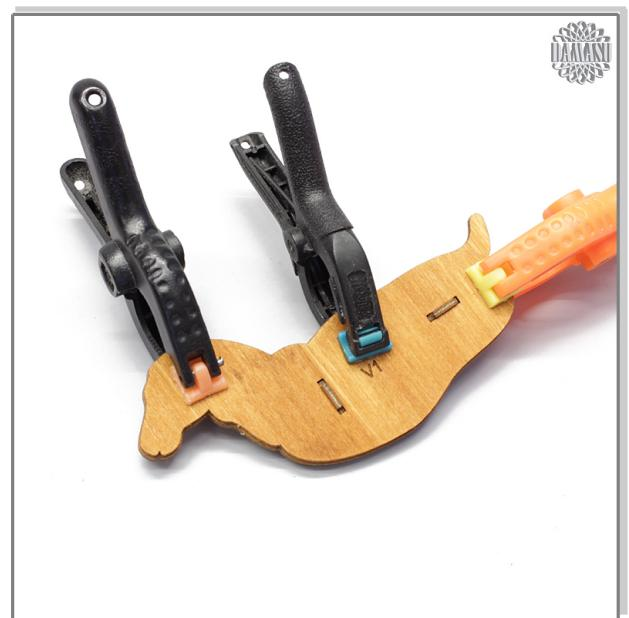
Die äußeren vier Schichten bilden dabei die Beine des Tieres. Prüfen Sie beim Anleimen dieser Schichten den korrekten Stand des Hirsches. Sie können dazu die Schichten trotz der mittleren Führung etwas schieben.
