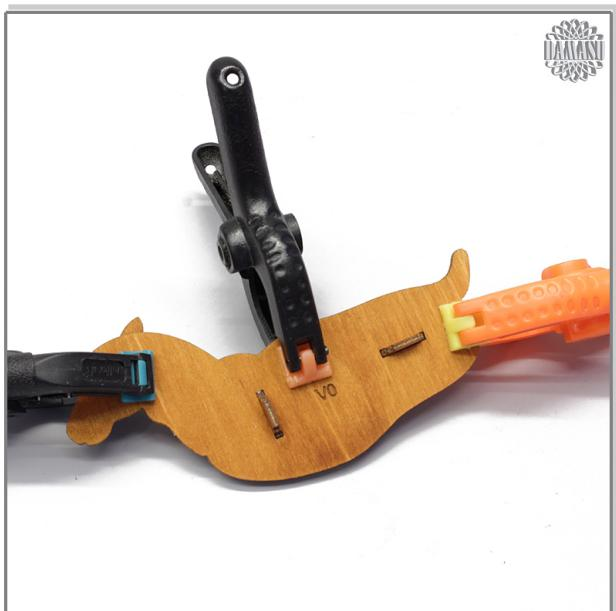
Zur besseren Führung können die trapezförmigen Teile mit eingesetzt werden. Die Aussparungen werden mit steigender Nummer der Seitenteile immer kleiner. Die Stufen der trapezförmigen Teile folgen genau diesem Muster.
